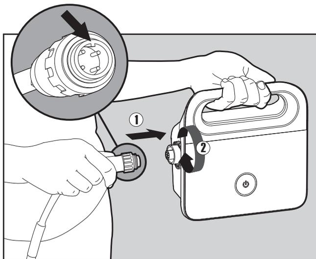
**5.1.3** Raccordez le câble bleu au boîtier d'alimentation électrique en l'insérant avec le cran sur le connecteur (1), aligné sur la rainure dans la prise du boîtier d'alimentation électrique. Tournez-le dans le sens des aiguilles d'une montre (2).
