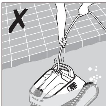
5.4.2 A l'aide du câble bleu, tirez le robot nettoyeur vers le bord de la piscine.
