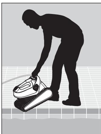
5.4.3 Déposez le robot nettoyeur sur le bord de la piscine et laissez l'eau s'écouler.
